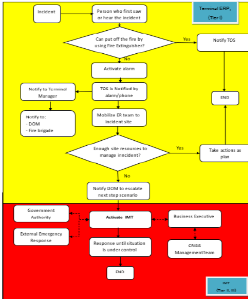
แผนภาพที่ 5 การแจ้งเหตุฉุกเฉิน (Emergency Notification Process)
