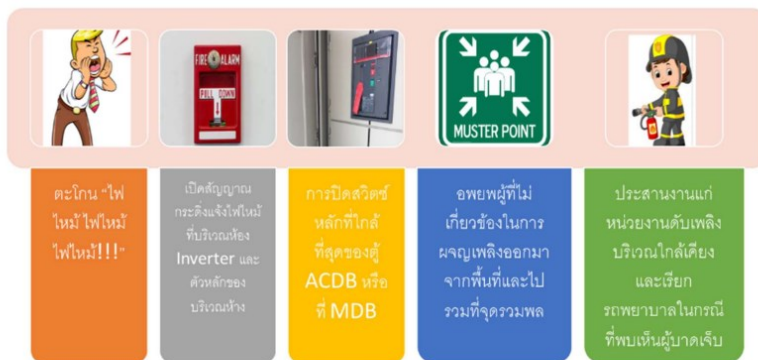
แผนภาพแสดงขั้นตอนการปิดระบบโซลาร์เซลล์ในกรณีฉุกเฉินและไม่ควบคุมสถานการณ์ได้
